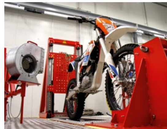
Am neuen Prüfstand kann nun auch ein Gesamtfahrzeug getestet werden.
