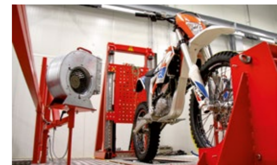
Am neuen Prüfstand kann nun auch ein Gesamtfahrzeug getestet werden.
