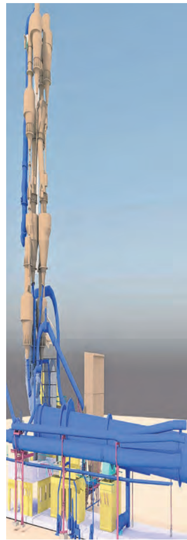
Das CAD-Modell eines Wärmetauscherturms in einem Zementwerk.
